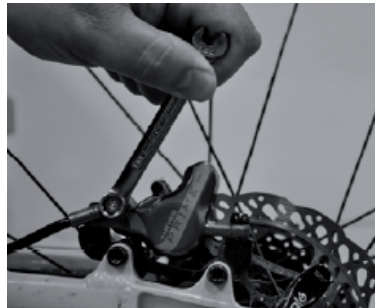
Zdjęcie 3. Poluzuj śrubę banjo i dostosuj kąt przewodu.
