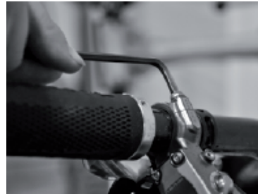
Zdjęcie 1. Dokręć mocowanie, tak by nie było szczeliny.
