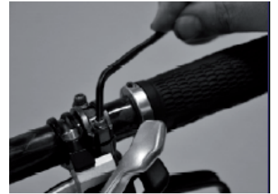
Zdjęcie 2. Dokręć dolne mocowanie momentem 30 \pm 5 in-lbs ( 3.37 \pm 0.55 Nm).
